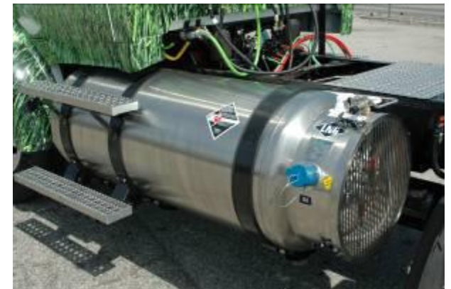
65 DGE LNG tank 505 lbs empty 883 lbs full
