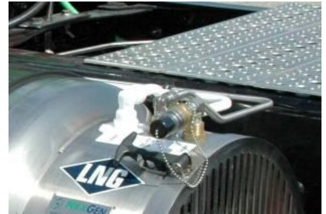
65 DGE LNG tank 505 lbs empty 883 lbs full
